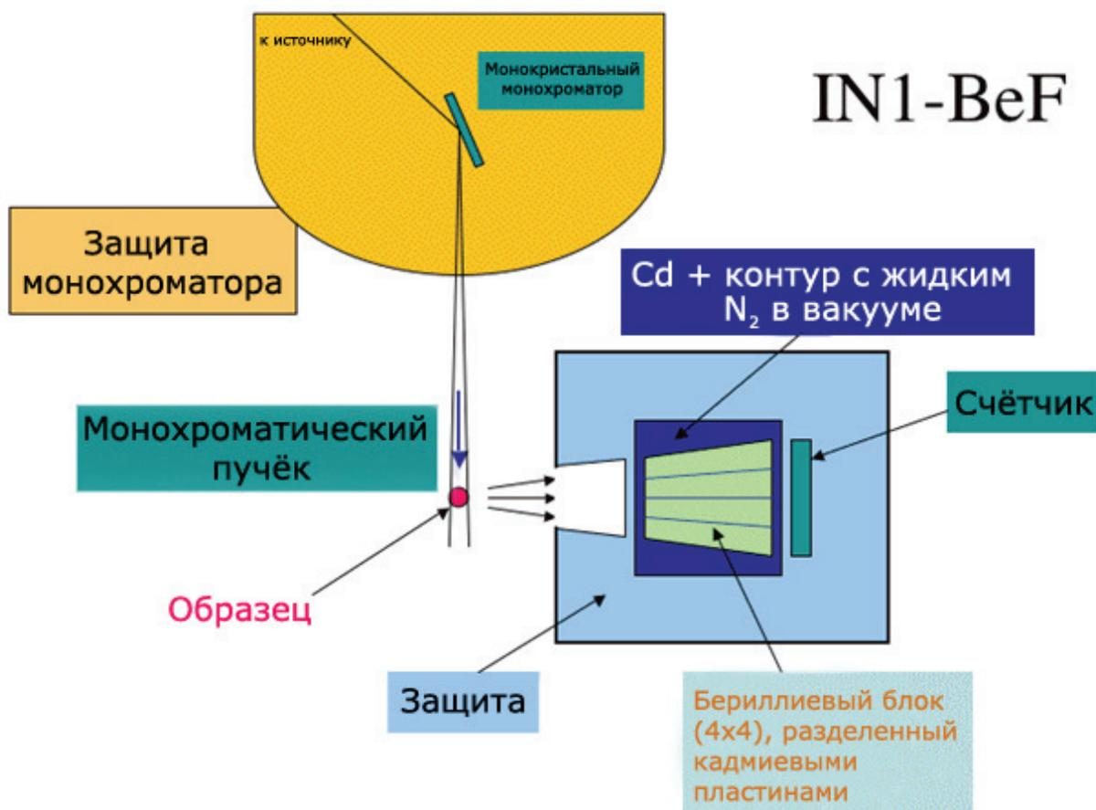
Рис. 2.5. Схема нейтронного спектрометра прямой геометрии с бериллиевым фильтром IN-1 BeF [69].
