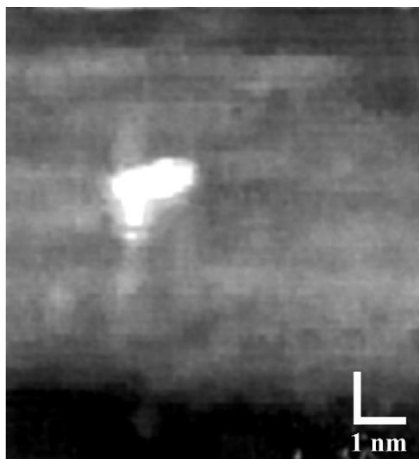
Рисунок 3.9. СТМ-изображение одиночной молекулы таллиевого производного карборанового кластера 1.7-(CH_3)_2-1.2-C_2B_{10}H_9Tl(OCOCF_3)_2 .
