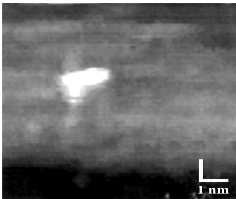
Рисунок 2.3. СТМ-изображение одиночной молекулы таллиевого производного карборана.
