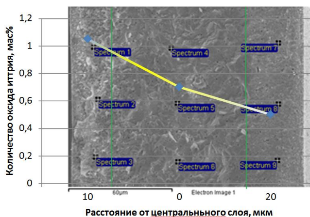
Рис. 2. Изучение элементного состава образца 6ScSZ/10ScYSZ/6ScSZ Таблица 1. Распределение химических элементов в каждой точке образца 6ScSZ/20Yb8Y2ScSZ /6ScSZ
