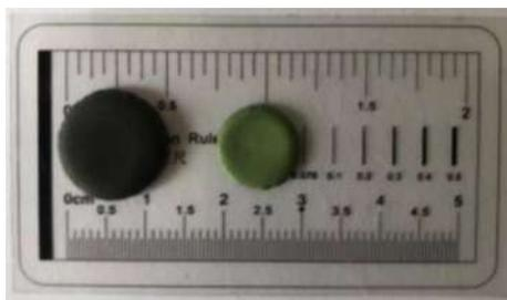
**Рисунок 1** - Образец полученный метод прямой струйной печати.
