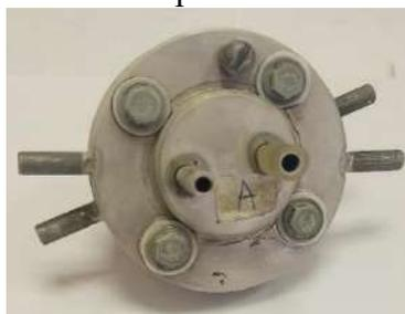
Рисунок 1 - Внешний вид ячейки ТЭ после замораживания ( $1 \text{ см}^2$ ) в сборе.
