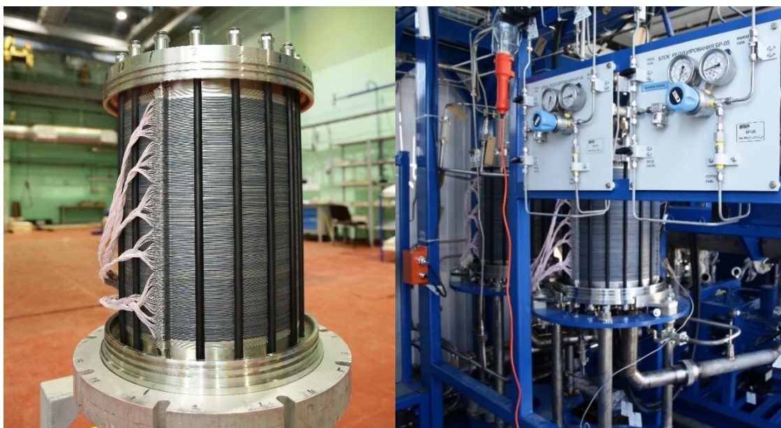
Рисунок 2. Батарея электролизных элементов (слева, без защитного кожуха) и секция электролизного модуля (справа, две независимых электролизных батареи).
