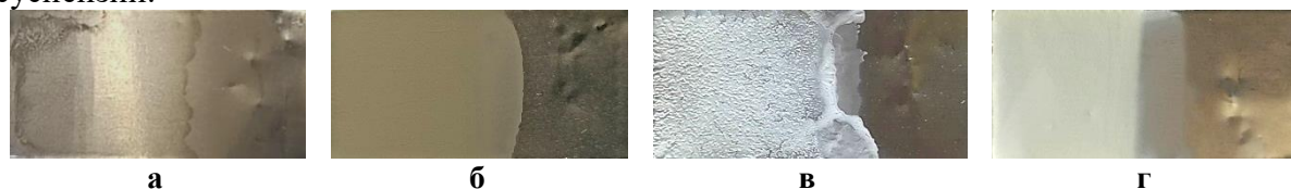
Рисунок 1. Фото ЭФО-покрытий, полученных из суспензий на основе SDC_micro: (а) - \text{Co}_3\text{O}_4 без SDC_nano; (б) - \text{Co}_3\text{O}_4 с SDC_nano; (в) - \text{Al}_2\text{O}_3 без SDC_nano; (г) - \text{Al}_2\text{O}_3 с SDC_nano.
