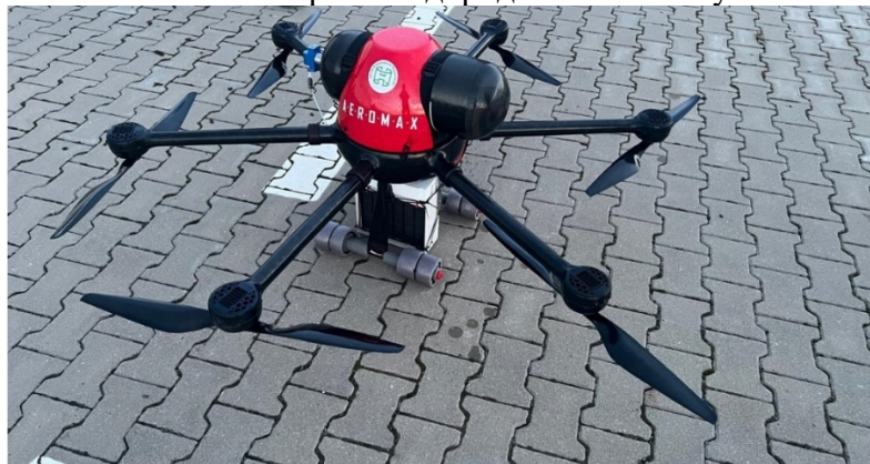
Рисунок 1. Беспилотный летательный аппарат с водородной энергетической установкой.
