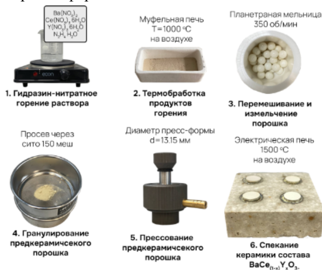
Рисунок 1. Технологическая схема синтеза порошков и спекания керамики на основе Y-допированного церата бария ( \text{BaCeO}_3 ) методом гидразин-нитратного горения
