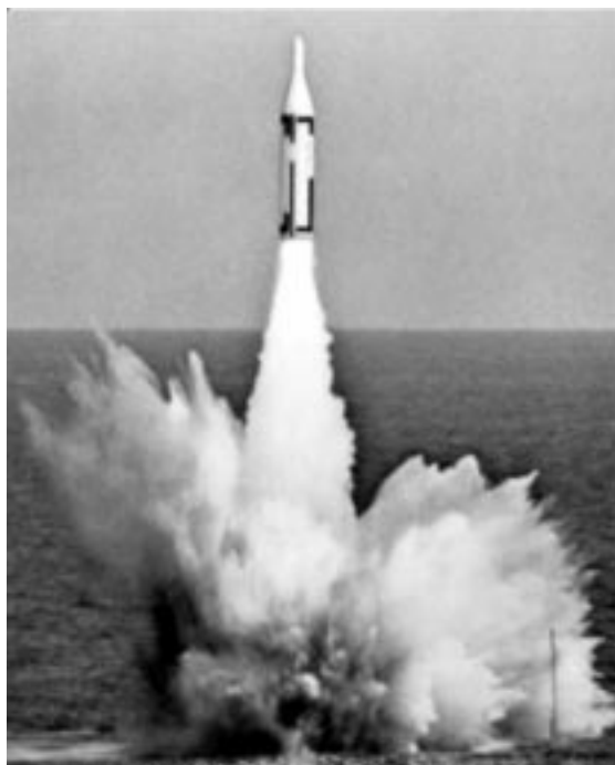
Рис. 2. Одна из первых ракет системы «Поларис» смотанным стеклопластиковым корпусом Early Polaris missile with glass fibre filament wound casing
