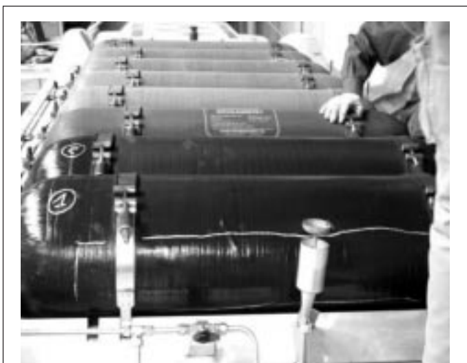
Рис. 9. Мотанные сосуды давления в парижском автобусе (предоставлено Банселлом) Filament wound pressure vessels on a Paris bus- courtesy A. Bunsell
