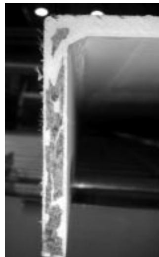
Рис. 7. Поперечное сечение профиля со вставками из углеродного волокна A cross section of the profile with carbon fiber inserts
