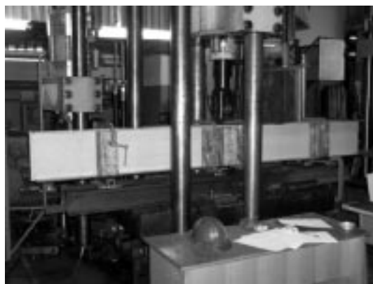
Рис. 8. Установка для испытания швеллера Testing machine for U-profile
