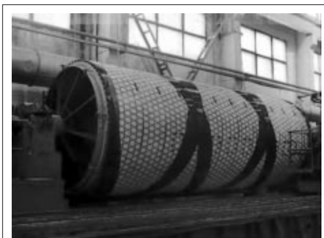
Рис. 4. Намотка на оправку, покрытую пенопластом (1985) Winding on the mandrel with foam coating (1985)
