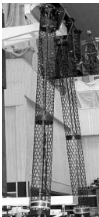
Рис. 25. Конструкция из сетчатых композитных стержней Space structure assembled of Anisogrid composite beams
