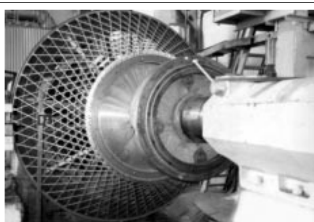
Рис. 6. Обработка наружной поверхности адаптера Machining of the adapter outer surface
