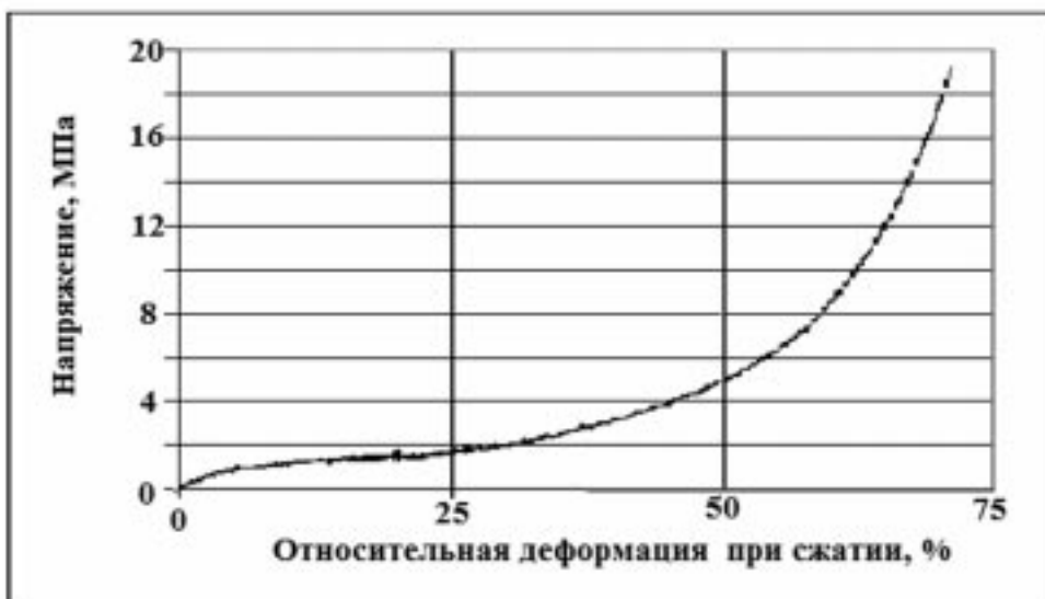
Рис. 7. Кривая сжатия пены из нержавеющей стали (пористость 93%)
