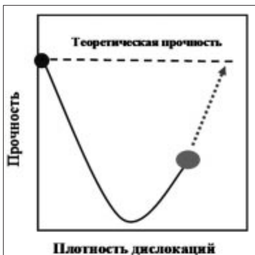
Рис.1. Схематическая зависимость прочности материала от плотности дислокаций [5, 6]
