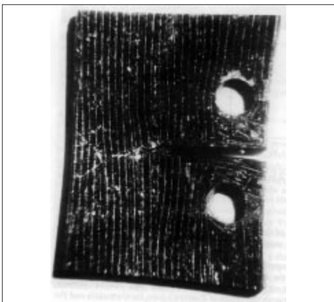
Рис. 3. Образец после Mo-Al_2O_3 измерения величины критического коэффициента интенсивности напряжений
