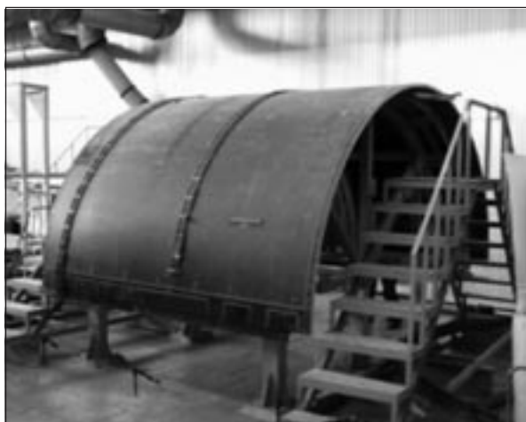
Рис. 1. Цилиндрическая оболочка головного обтекателя ракеты-носителя «Протон-М»
