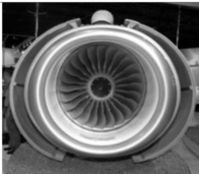
Рис. 12. Композитная панель шумоглушения авиадвигателя SaM-146
