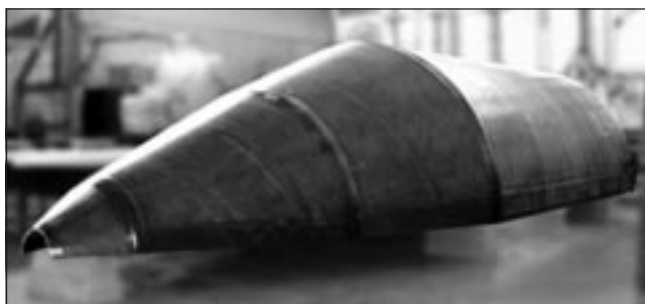
Рис.2 Интегральная оболочка головного обтекателя ракеты-носителя «Ангара»
