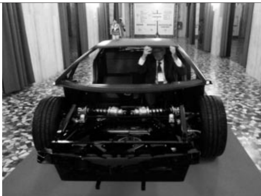
Рис. 7. Кузов спортивного автомобиля фирмы Ламборджини выполнен из углепластика
