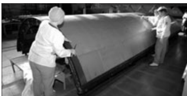
Рис. 3. Выкладка обшивки для обтекателя ракеты-носителя
