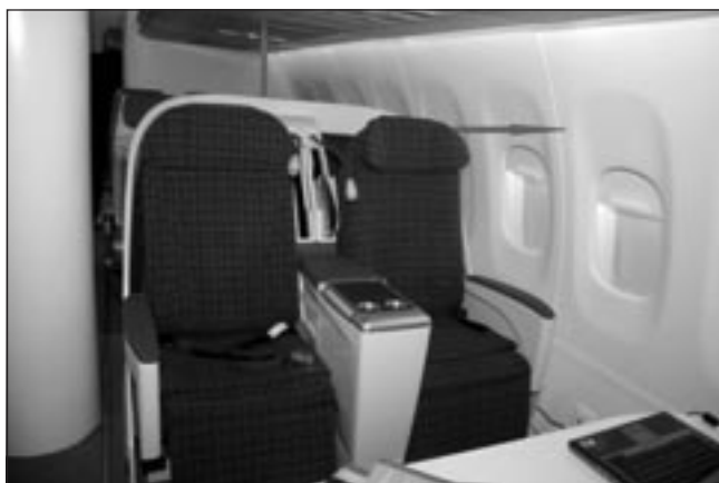
Рис. 9. Интерьер салона самолета, выполненный из углепластика
