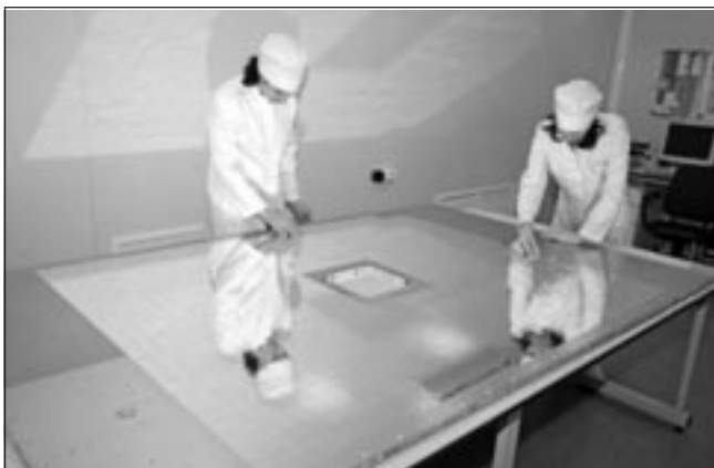
Рис. 6. Контроль качества панели терморегулирования
