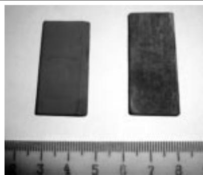
Рис. 6. Образцы композита  $\text{Al}_2\text{O}_3$ - $\text{Y}_3\text{Al}_5\text{O}_{12}$ /Мо, покрытые слоем хрома – до испытания (слева) и после пребывания в струе продуктов сгорания керосина с температурой газа 1300 °С в течение 20 часов (справа)
