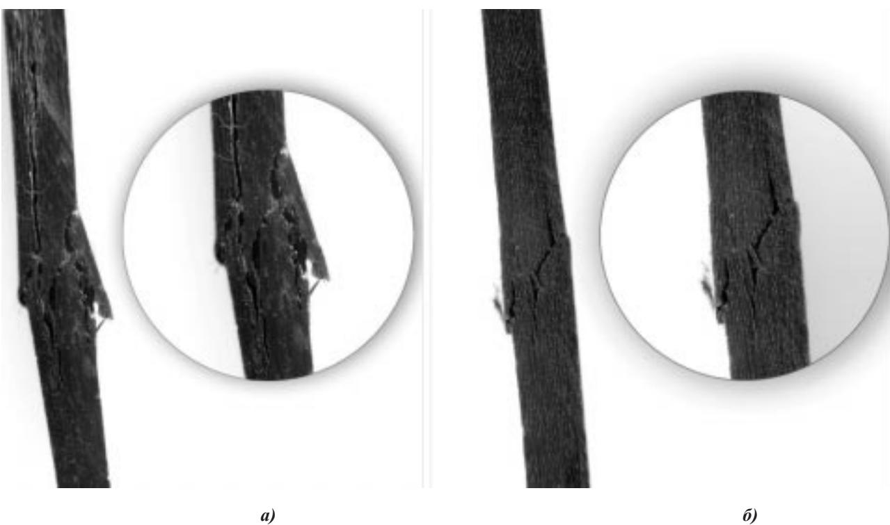
*Рис. 3. Характер разрушения образцов углепластика, подвергнутых ударным нагрузкам при испытании на сжатие (см. объяснение в тексте)*
