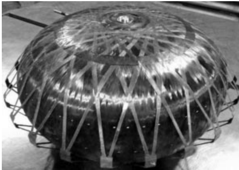
Рис. 7. Элементы крепления баллона к корпусу космического аппарата
