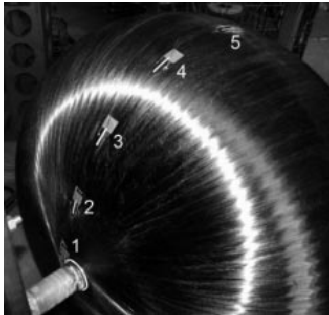
Рис. 4. Расположение тензодатчиков на баллоне
