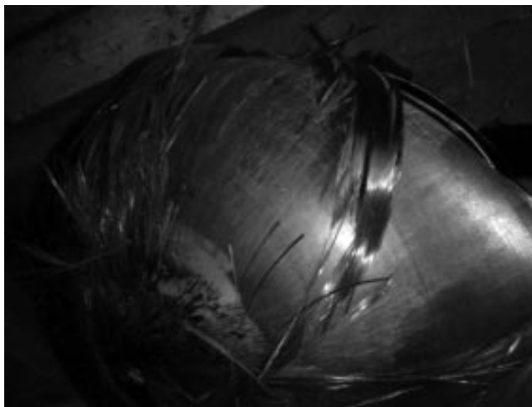
Рис. 6. Форма разрушения баллона
