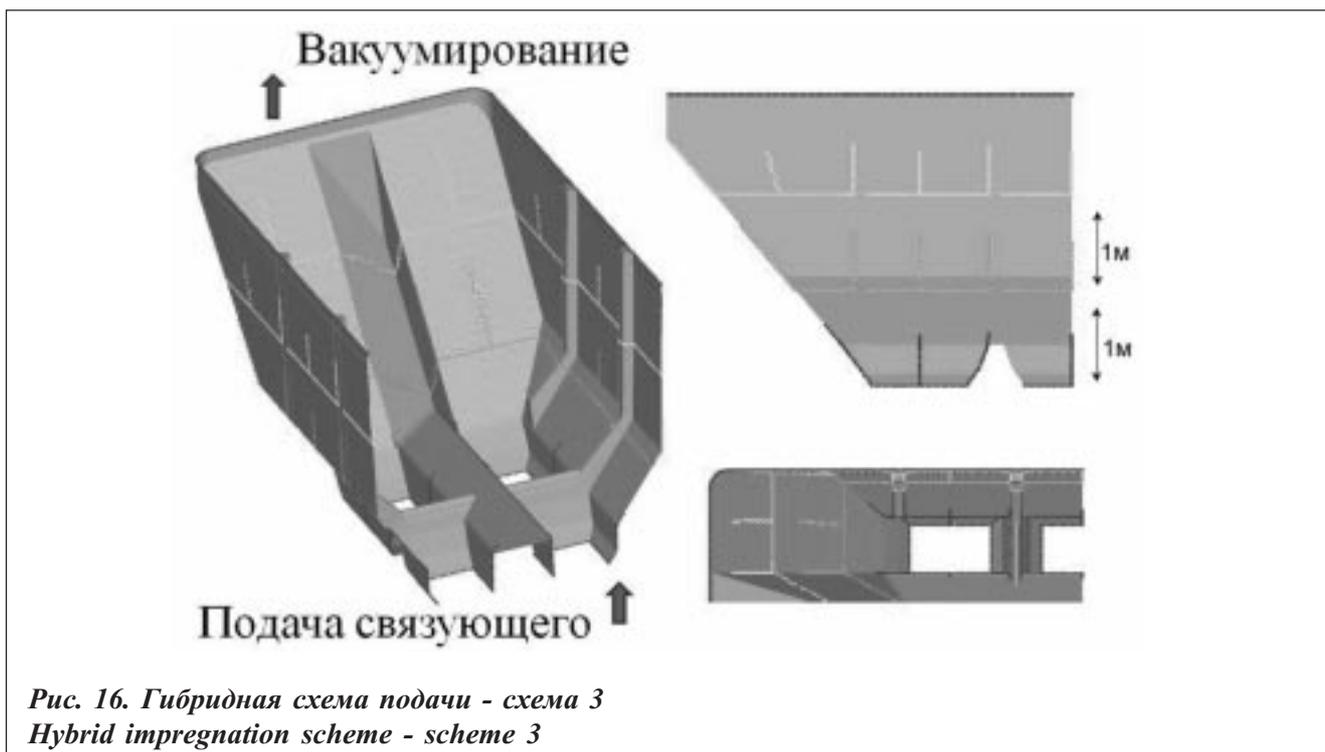
Рис. 16. Гибридная схема подачи - схема 3
