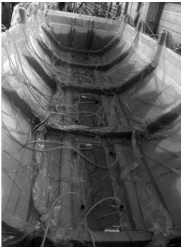
*Рис. 9. Процесс пропитки полноразмерной крыши вагона хоппера.*
