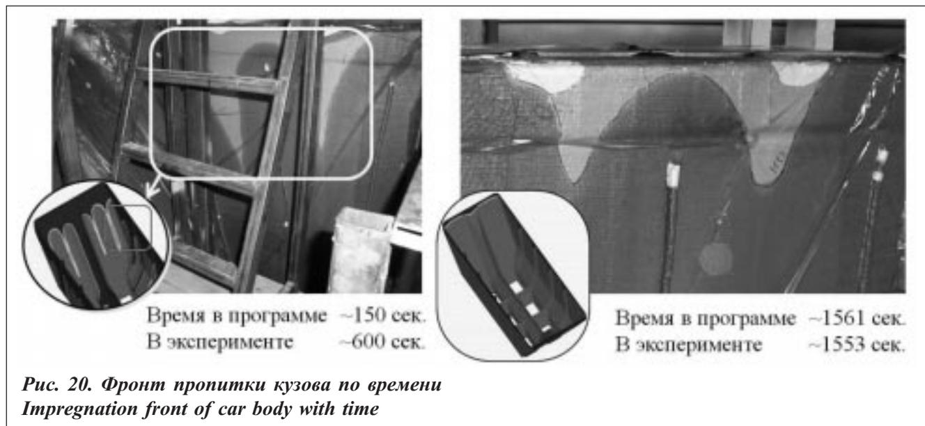
Схема, применённая технологами, позволила пропитать кузов полностью с первого раза с необходимым запасом по времени до момента начала застывания связующего.
