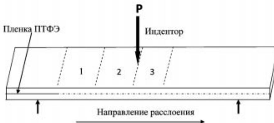
Рис. 1. Схема нагружения с зонами разрушения образца слоистого полимерного композита (углепластика) при испытании на трещиностойкость по моде II (межслоевого сдвига): 1, 2, 3 - зоны разрушения
