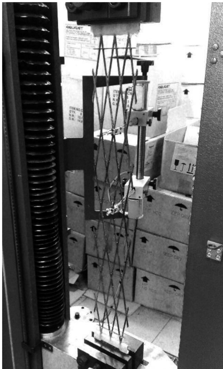
Рис. 6. Испытания элемента сетчатой структуры на сжатие Compression test of the lattice structural element
