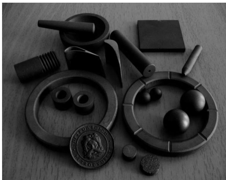
Рис. 4. Образцы изделий сложной формы, изготовленные с использованием особенностей безусадочной технологии. Изделия сложных форм с заданным рельефом поверхности могут быть изготовлены из ДУКМ алмаз/SiC повышенной твердости и износостойкости
