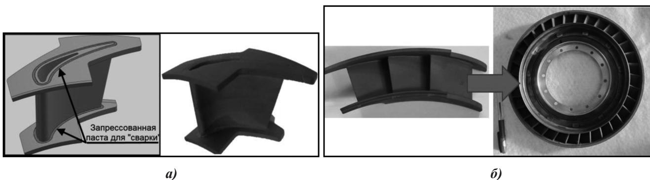
Рис. 6. Технология соединения деталей из ДУКМ алмаз/SiC (а) и опытный СА модифицированной конструкции (б)
