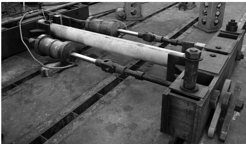
Рис. 3. Осевое сжатие экспериментальной колонны Axial compression of an experimental column
