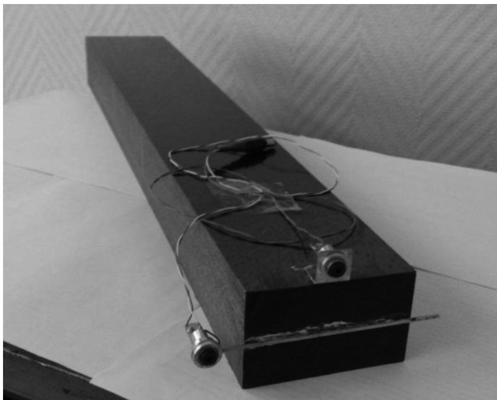
Рис. 3 Экспериментальная композитная балка Experimental composite beam
