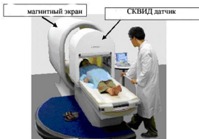
Рис. 1. Внешний вид 51-канальной системы на ВТ СКВИДах для магнитокардиографии.
