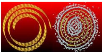
Рис.1. Углеродные наносвитки – аккумуляторы водорода [3]
