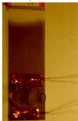
Рис.4. Устройство для электростимуляции клеток. Два кольца (камеры для клеток и жидкой среды) помещены на многослойную композитную пленку; провода присоединены к области ОСНТ при помощи серебряной пасты и медной ленты.
