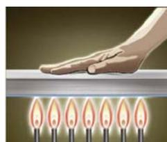
Рис.3. Термический барьер из полимера с добавками 1 масс.% УНТ (THERMOCYL™) [2].
