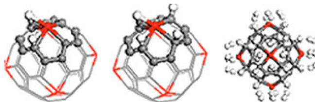
Рис. 2. Геометрическая структура системы  $Ti_6C_{48}$  [5]. Красным показаны атомы Ti, белым - H. Слева направо: диссоциация первой молекулы водорода на атоме Ti в  $Ti_6C_{48}$ ; диссоциация второй молекулы водорода на атоме Ti в  $Ti_6C_{48}$ ; система  $Ti_6C_{48}$ , связанная с 36 молекулами водорода
