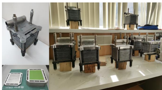
Фото 2. Батареи планарных твердооксидных топливных элементов, разработанные и изготовленные в ИФТТ РАН.
