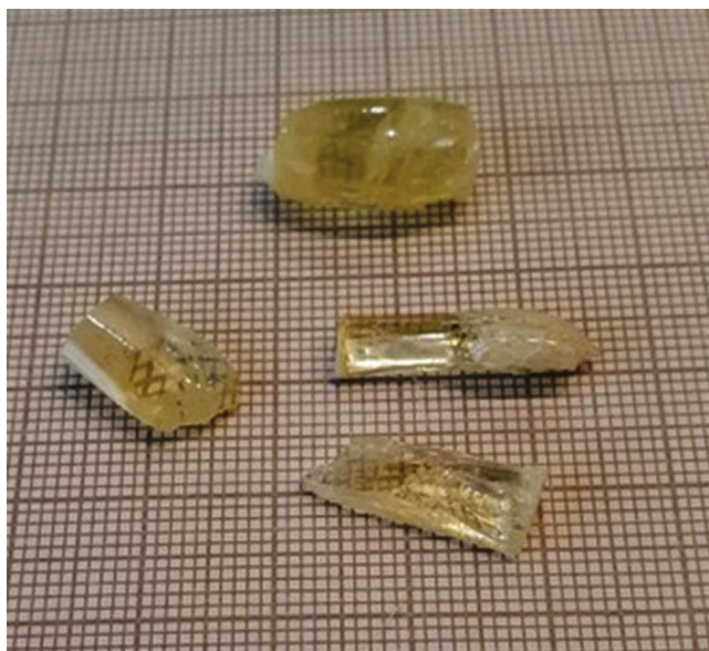
Рис. 1. Образцы из кристалла K_5Gd_{0.95}Ho_{0.05}(MoO_4)_4 .
