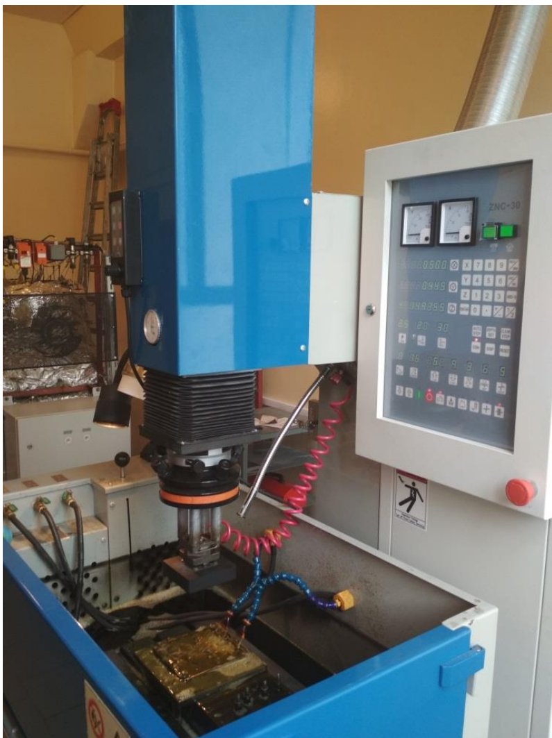
Фотография электроэрозионного копировально-прошивочного станка с ЧПУ D7125
