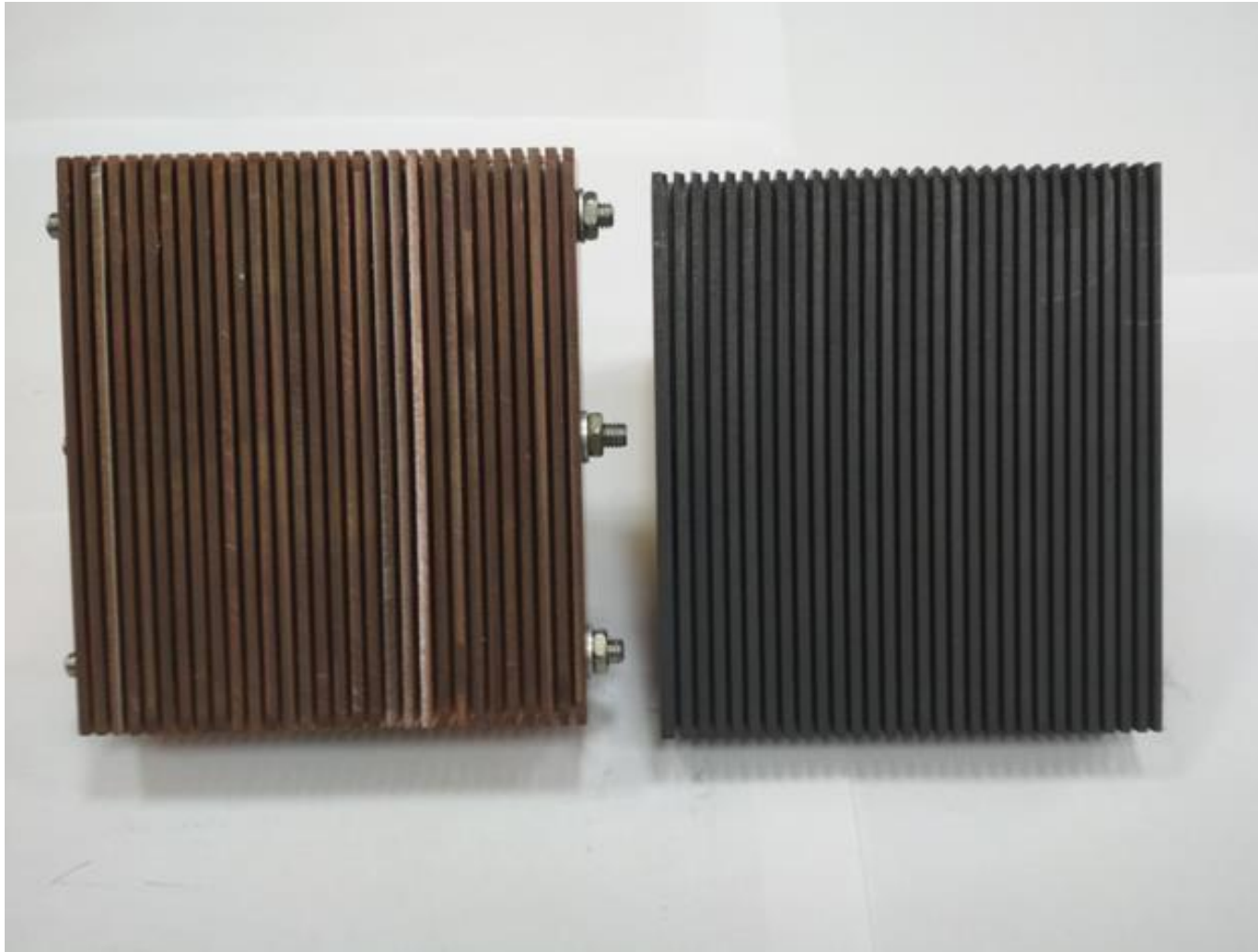
Медный и графитовый электроды для электроэрозионного станка
