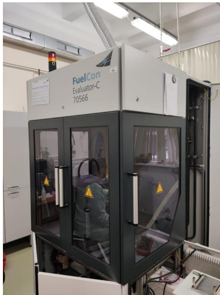
Испытательный стенд FuelCon Evaluator C-1000 для электрохимических испытаний
