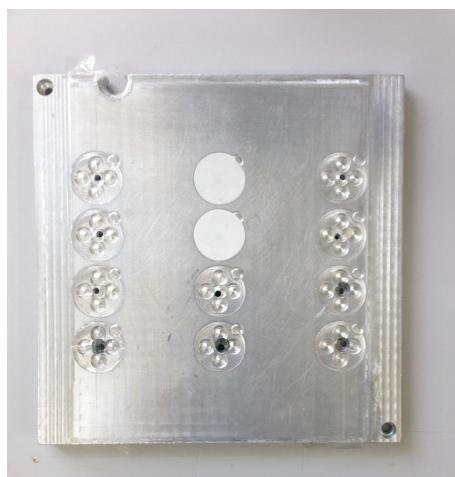
**Рис. 2.2:** Фото подставки для образцов диаметром 21 мм.
