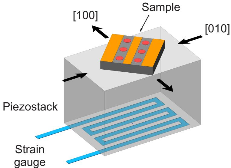
Рис. 5.1: Схематический вид пьезоактуатора с наклеенными на противоположные стороны образцом и резистивным тензодатчиком. Кристаллографические направления показаны стрелками.
