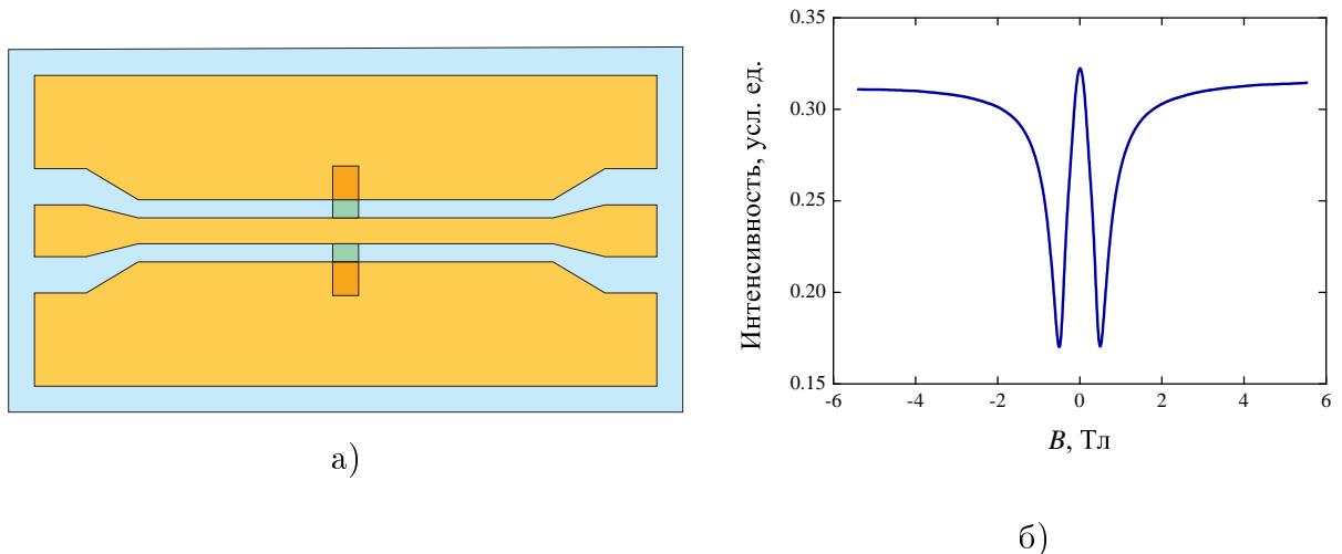
Рис. 3.6: а) Схематическое изображение образца, используемого в копланарной методике; б) Пример экспериментальной зависимости прохождения СВЧ-сигнала между затворами от магнитного поля в данной методике, на которой видны симметричные относительно нулевого магнитного поля резонансы.
