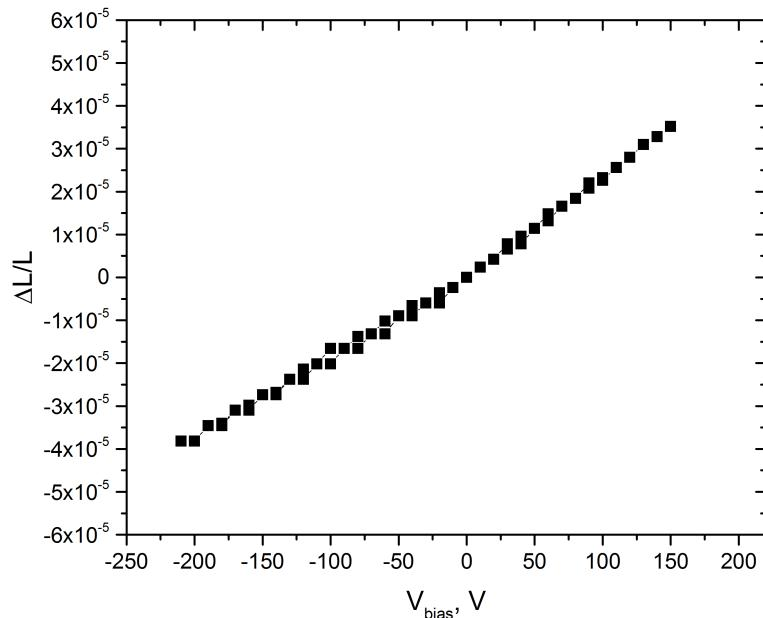
Рис. 5.3: Зависимость между деформацией пьезоактуатора и напряжением, подаваемым на него.
