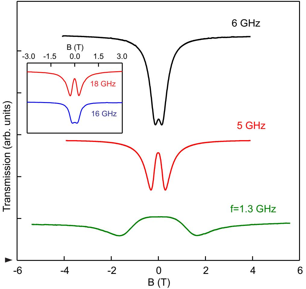
Рис. 4.1: Магнитополевые зависимости пропускания копланарный волновода на частотах 1.3 GHz, 5 GHz, and 6 GHz. На каждой кривой хорошо видны резонансы, соответствующие краевому магнитоплазмону. На вставке показано пропускание КВ для 16 GHz и 18 GHz. Резонансы демонстрируют позитивную магнитодисперсию, свойственную циклотронной моде. Электронная концентрация в экспериментах была  $n_s = 1.7 \times 10^{11} \text{ cm}^{-2}$  при температуре  $T = 1.5 \text{ K}$ .
