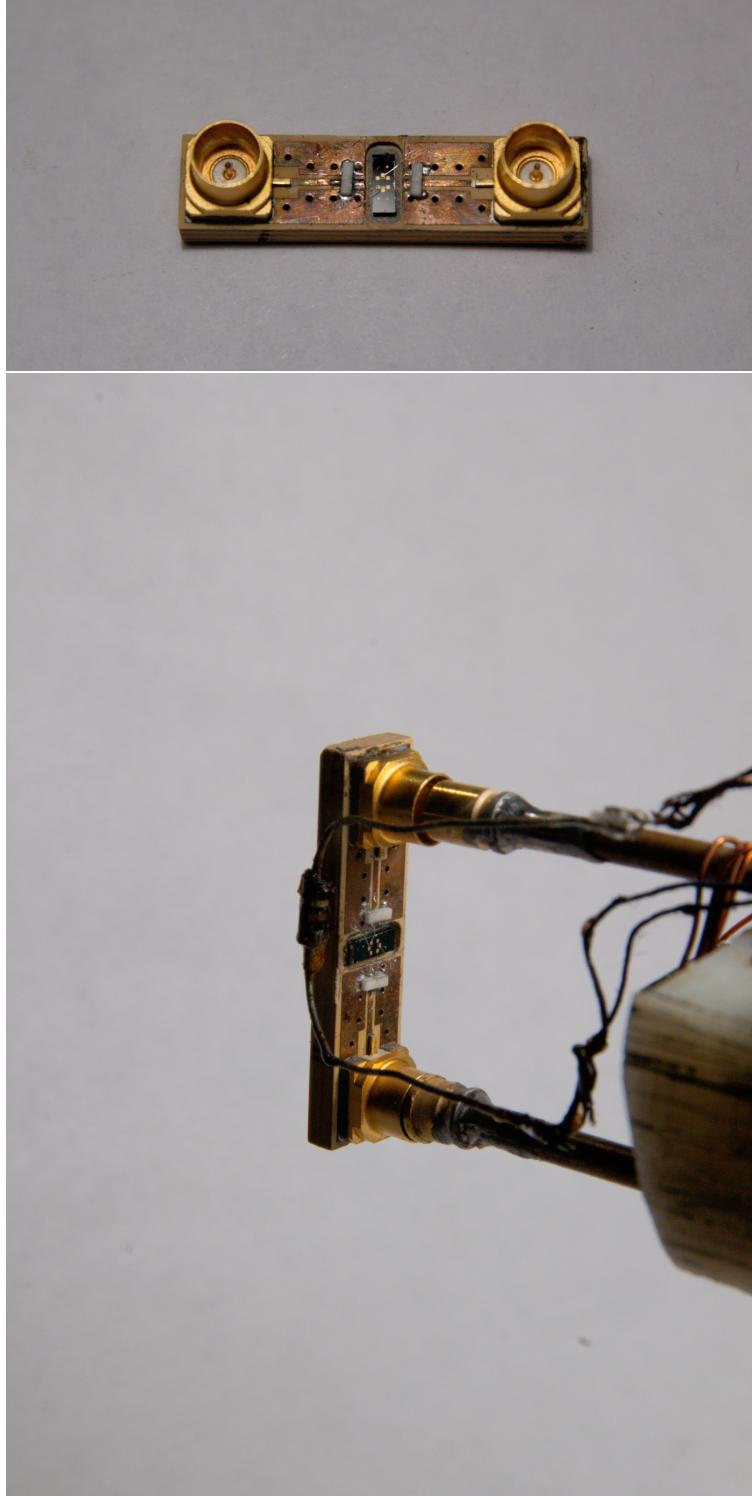
Рис. 3.4: Держатель с вмонтированным на нём образцом, а также держатель, закреплённый на конце низкотемпературной вставки.
