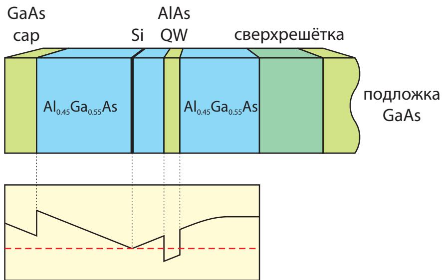
Рис. 3.1: Последовательность слоёв и энергетическая диаграмма гетероструктуры. При температуре  $T = 0$  К все уровни ниже энергии Ферми  $E_f$  заняты.
