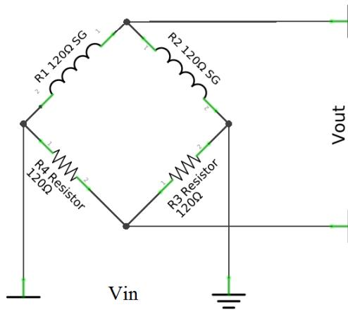
Рис. 5.2: Схематическое изображение мостовой схемы измерений.
