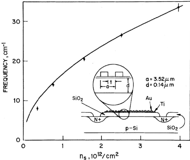
Рис. 1.3: Положение плазменных резонансов, измеренное в зависимости от электронной плотности  $n_s$ . Сплошная линия показывает теоретическую зависимость на основе выражения 1.4. На вставке изображено поперечное сечение МОП-структуры с напылённым решётчатым затвором. (Взято из статьи [11]).
