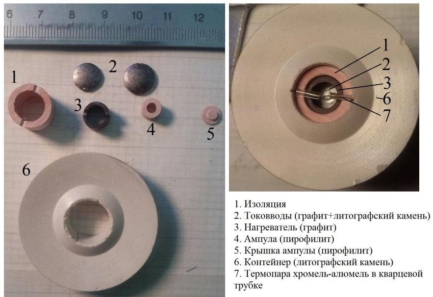
Рис. 3.1: Изображение контейнера для синтеза черного фосфора методом высокого давления.
