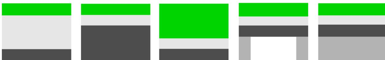
Рисунок 3. Сравнительные толщины составных частей планарных ТОТЭ для различных несущих компонентов (слева направо): электролит, катод, анод, токоприёмник, подложка. Сверху вниз: анод, электролит, катод,
