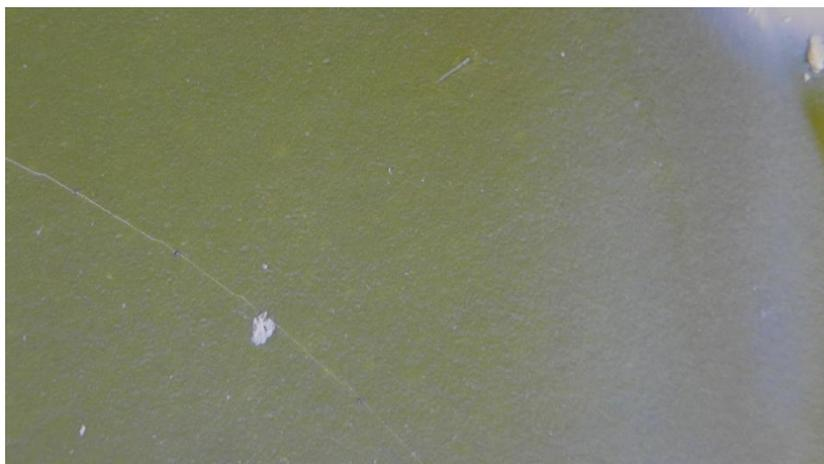
Рисунок 23. Фотография агломерата на поверхности анодной подложки, сделанная в оптический микроскоп
