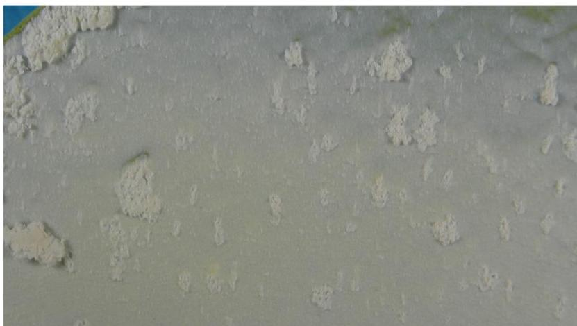
Рисунок 21. Фотография плёнки SOFCMAN с присутствующими на ней агломератами, сделанная в оптический микроскоп
