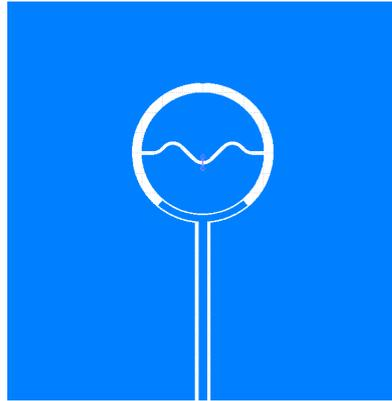
Рисунок 2.6 — Модель трансмона и резонатора в Ansys Maxwell
