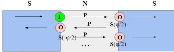
Рис. 11: Процессы переотражения в SNS-структуре.
