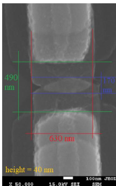
Рис. 20: СЭМ-изображение SNS-структуры с указанием геометрических размеров.
