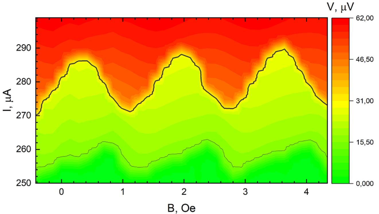
Рис. 22: Зависимость  $V(I)$  для СКВИДа при разных значениях магнитного поля  $B$ . Сплошной линией выделены осцилляции критического тока в магнитном поле.
