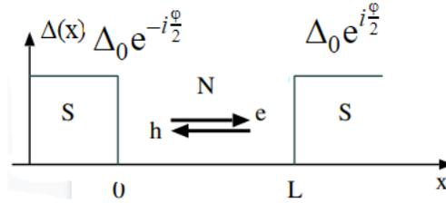
Рис. 8: Сверхпроводящая щель  $\Delta(x)$  для баллистического одномерного SNS контакта. Стрелками показаны направления групповых скоростей электронов и дырок. [5]
