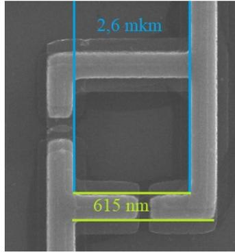
Рис. 23: СЭМ-изображение СКВИДа с указанием геометрических размеров. Высота слоя  $s = 40$  нм.
