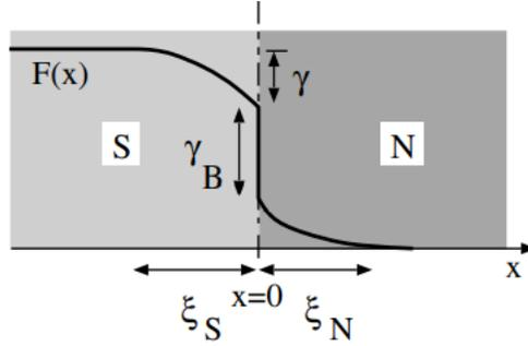
Рис. 14: Схематическая зависимость плотности куперовских пар  $F(x) = \text{Re}[\sin \theta_{S,N}(x)]$  от координаты. [5]
