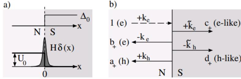
Рис. 6: (а) Модель NS-интерфейса. (б) Модель рассеяния, учитывающая андреевское и обычное отражения. Стрелки отображают направления групповых скоростей, коэффициенты – амплитуды вероятности соответствующих состояний. [5]
