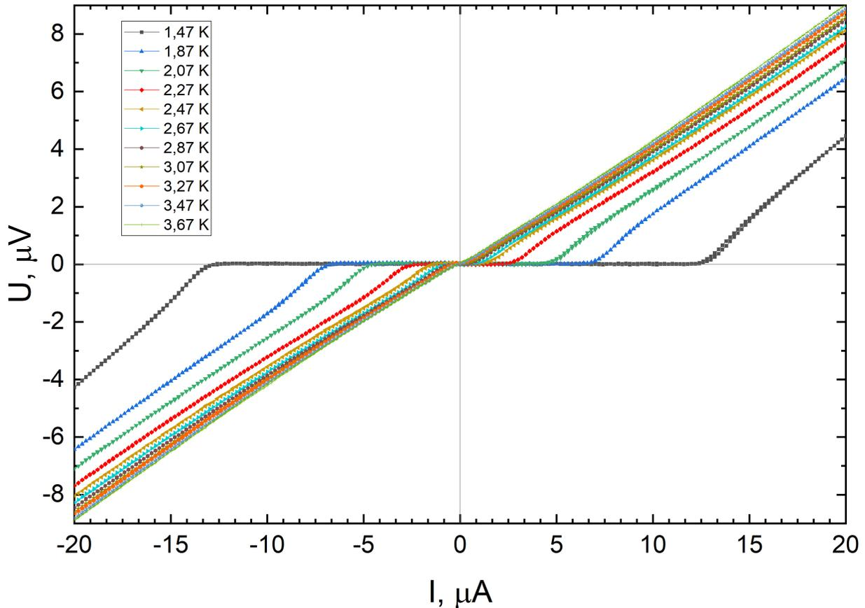
Рис. 19: Результаты измерений вольт-амперных характеристик SNS-контакта (Nb-Cu-Nb) при различных температурах.
