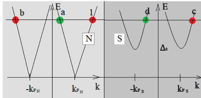
Рис. 7: Положения электронов (выделены красным цветом) и дырок (выделены зелёным цветом) с соответствующими коэффициентами по амплитуде на дисперсионных кривых металла и сверхпроводника.
