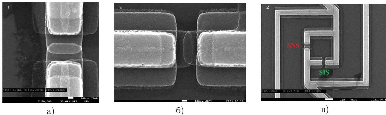
Рис. 16: СЭМ-изображения изготовленных структур для эксперимента: а) отдельный SNS-контакт б) отдельный SIS-контакт в) СКВИД с SNS- и SIS-контактами (обозначены на рисунке).
