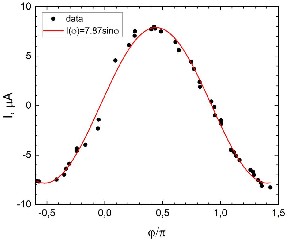
Рис. 24: Ток-фазовое соотношение SNS-контакта, полученное из экспериментальных данных (точки, отмеченные чёрным цветом), и его аппроксимация аналитической зависимостью (сплошная красная линия).
