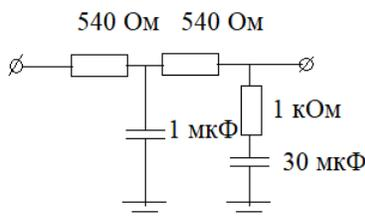
Рис. 18: Схема фильтров низких частот, установленных на выходе из криостата.
