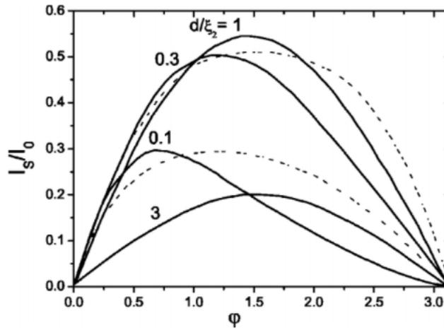
Рис. 25: Зависимость ТФС от отношения длины N-слоя к длине когерентности в металле в диффузионном случае. Численный расчёт показан сплошными линиями, аналитический – пунктиром. [1]
