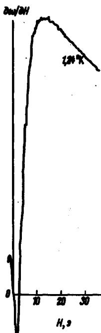
Запись производной по полю от мнимой части поверхностного импеданса пластиинки калия толщиной 0,6 мм. Частота 6,25 Мгц,  $j \perp H$
