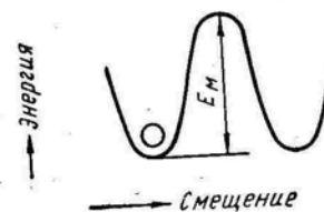
Рис. 10. Изменение энергии атома при перемещении его в вакантный узел
