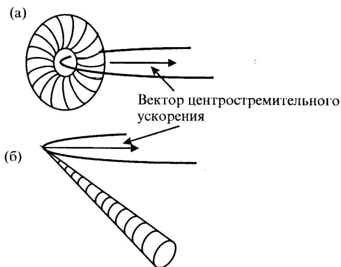
Рис. 2.2.1. Распределение излучения электрона при движении по круговой орбите: (а) v \ll c , (б) 1 - v/c \ll 1
