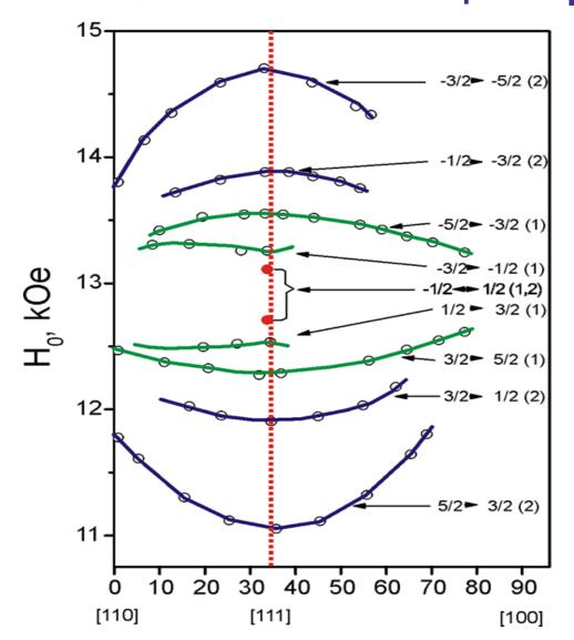
Наблюдались два типа спектров ЭПР ионов 10 ухвалентного марганца с разрешенной тонкой и серхтонкой структурами. На рис. представлена угловая зависимость положения линий спектра ЭПР двух (тетраэдрического-1 и октаэдрического-2) центров ионов Mn<sup>2+</sup> в плоскости {110} для одного неэквивалентного положения при T=77K.
