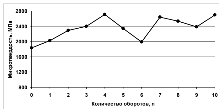
Рис. 1. График изменения микротвердости сплава Cu-0,6%Cr-0,1%Zr в процессе обработки методом ИПДК
