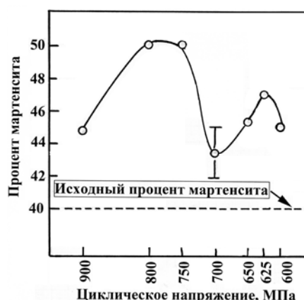
Рис. 2. Изменение содержания мартенсита в зависимости от уровня максимального циклического напряжения; при напряжении 700 МПа экспериментальная точка определялась по двум образцам
