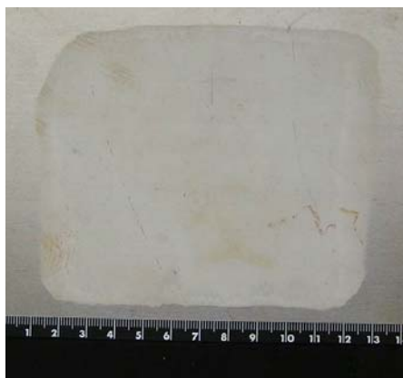
Рис. 1. След луча на поверхности Al после воздействия [2]
