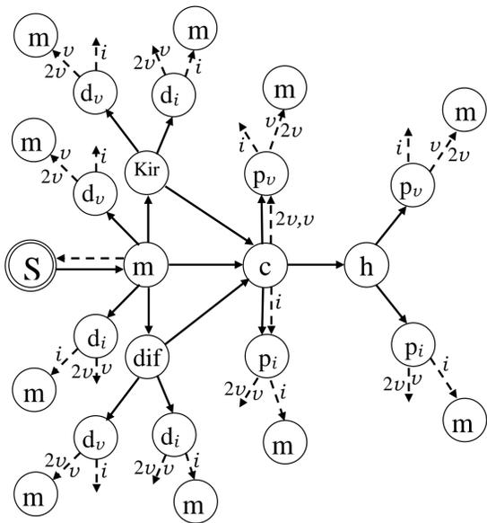
S – дислокационный источник; m – сдвигообразующие матричные дислокации; c – кольца Орована; h – ступенька на дислокационном кольце с винтовым сегментом p<sub>k</sub> – призматические дислокационные петли; d<sub>k</sub> – дислокационные диполи; i, 2v, 1v – диффузионное переползание дислокаций в результате осаждения на них соответственно межузельных атомов, бивакансий и моновакансий
