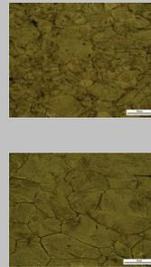
Значит разнообразие. Средний размер зерен 37мк (6-7 балл). Плавка №1. Лента (h = 0,8мм) в нагартованном состоянии (epsilon = 34%).
