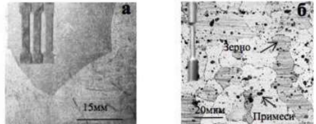
Рис. 1. Микроструктура, форма и схема расположения образцов в монокристалле (а) и поликристалле (б)
