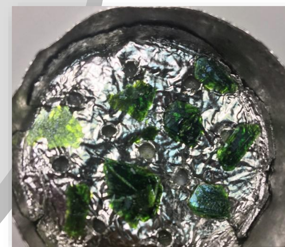
Синтезированные кристаллы на перфорированной фольге
