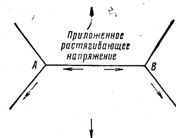
Рис. 11. 11. Развитие гидростатических напряжений вдоль поперечной границы зерна
