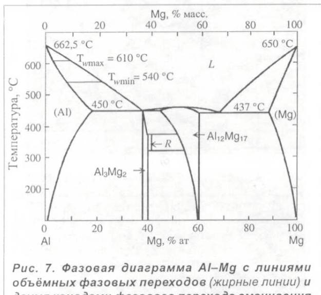
Рис. 7. Фазовая диаграмма Al–Mg с линиями объемных фазовых переходов (жирные линии) и двумя конодами фазового перехода смачивания при  $T_{w\max} = 610^\circ\text{C}$  и  $T_{w\min} = 540^\circ\text{C}$  (сплошные тонкие линии)
