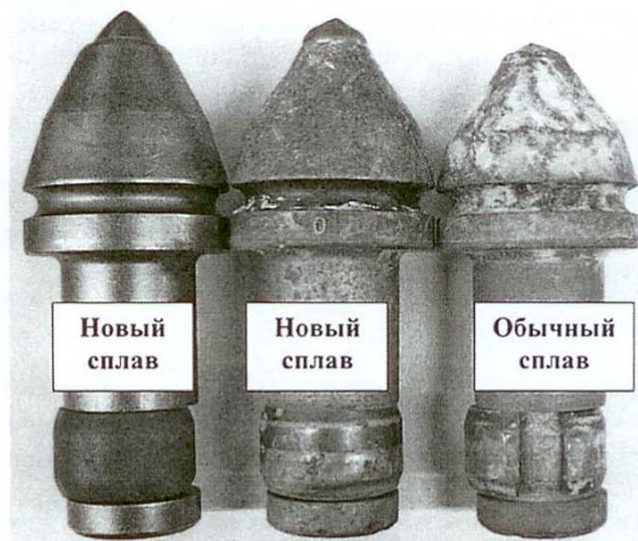
Рис. 4. Резцы с обычным и новым твердым сплавом до и после эксплуатационных испытаний при проходке туннеля (резание песчаника)
