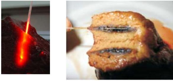
**Рис.4.** Эксперимент по облучению (пилотный лазер видимого диапазона) и вид области термического повреждения (8 Вт непрерывного излучения с длиной волны 810 нм в течение 14 минут) с зоной коагуляции
