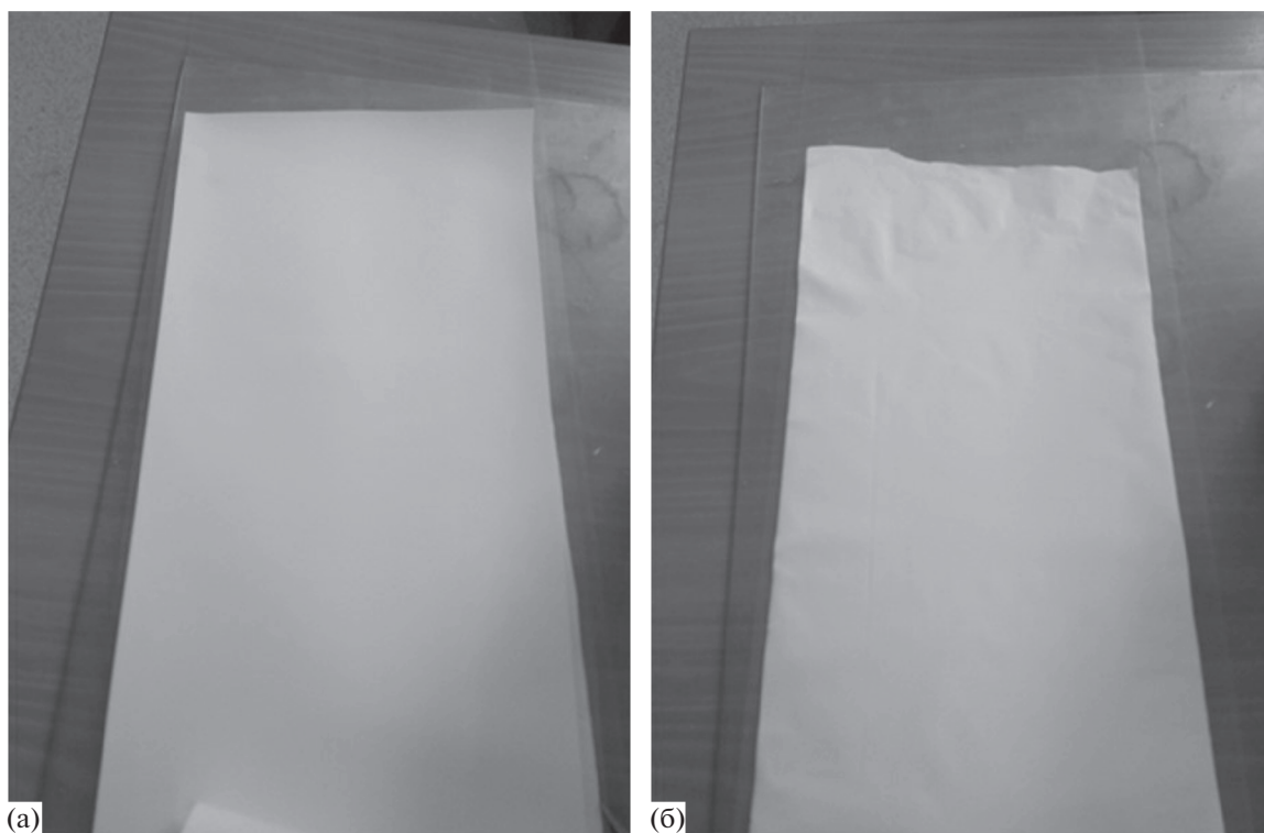
Рис. 9. Ленты 10Sc1YSZ, отлитые из шликера рецептуры R3 на ПЭТФ пленку без покрытия (а) и состава R4 на ПЭТФ-пленку с силиконовым покрытием (б).
