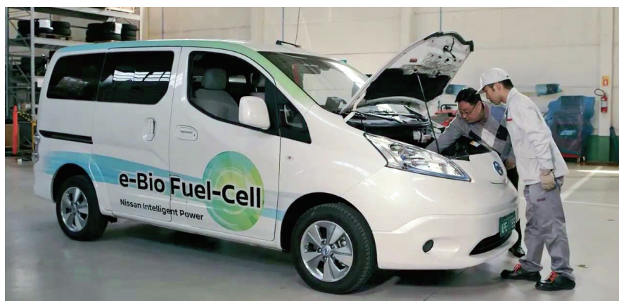
Рис. 2. Электромобиль с расширителем пробега на базе ТОТЭ, разработанный компаниями Nissan и AVL
