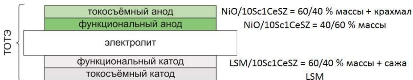
Рис. 2.27: Конструкция модельных образцов для исследования токогенерирующих процессов методом спектроскопии КРС
