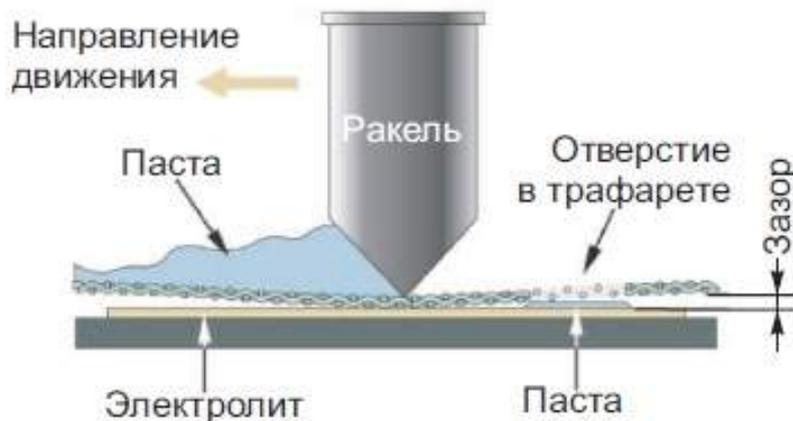
Рис. 2.40: Принцип работы метода трафаретной печати
