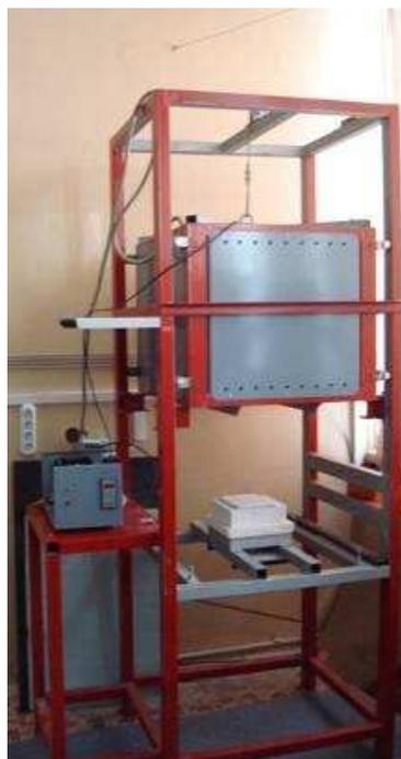
*Рис. 2.14:* Колпаковая печь для тестирования мембранно-электродных блоков и прототип батареи ТОТЭ
