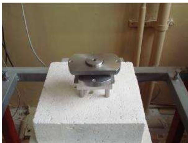
Рис. 2.15: Модуль после установки мембранно-электродного блока
