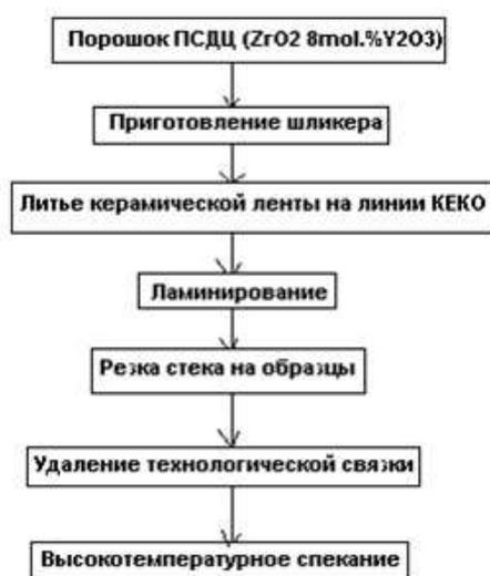
Рис. 2.2: Схема изготовления пластин твердого электролита
