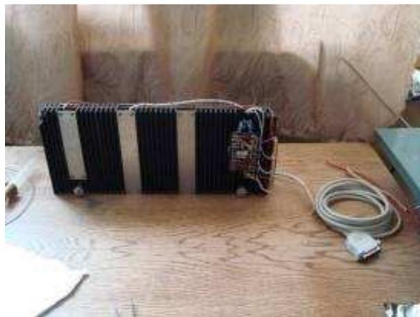
Рис. 2.12: Фотография электронного устройства стабилизации тока
