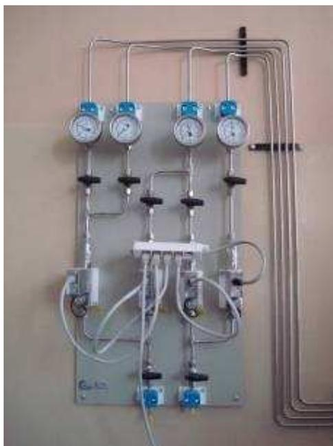
*Рис. 2.10: Фотография газораспределительного стенда*
