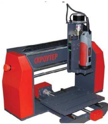
Рис. 2.6: Гравировально-фрезерный станок Роутер 3020
