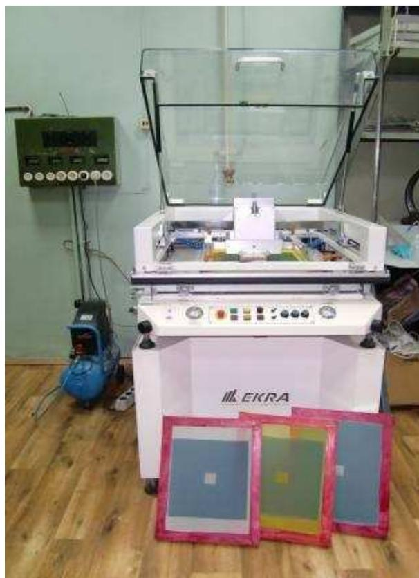
*Рис. 2.5:* Станок трафаретной печати «EKRA MAT S45»
